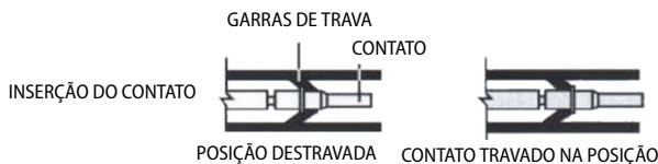
**Figura 7-15. Contatos de travamento HD/HDP na posição**
