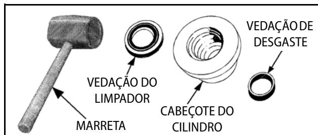
Nota: Ao instalar a velação do limpador, verifique se a velação está instalada adequadamente. Instale a velação de modo que a parte plana fique voltada para o cabeçote.
