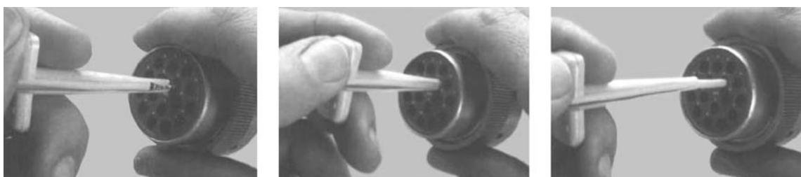
**Figura 7-16. Remoção de contato HD/HDP**
