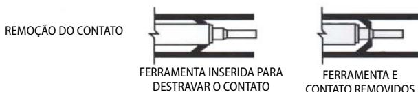
**Figura 7-17. Contatos de destravamento HD/HDP**
