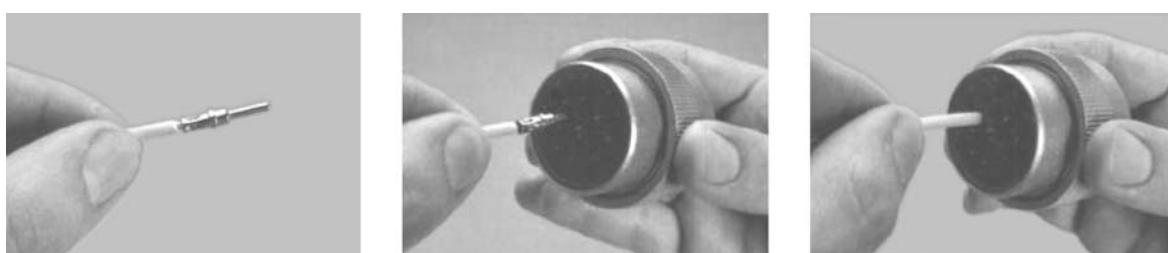
**Figura 7-14. Instalação de contato HD/HDP**
